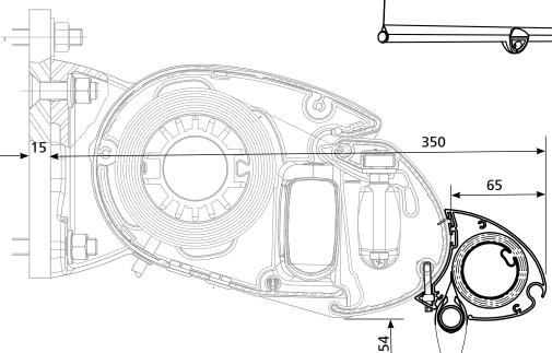
Coffre en aluminium extrudé laqué blanc ou ivoire. Équipé d'un tube d'enroulement en acier et d'une toile ajourée de hauteur maxi 1120 mm.
