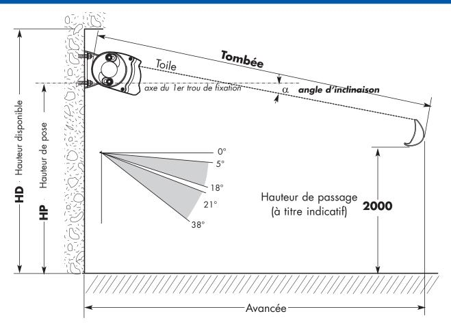
**HAUTEUR DISPONIBLE** fonction de l'angle d'inclinaison  $\alpha$  et de la tombée (calculée pour une hauteur de passage sous barre de charge de 2000 mm)
