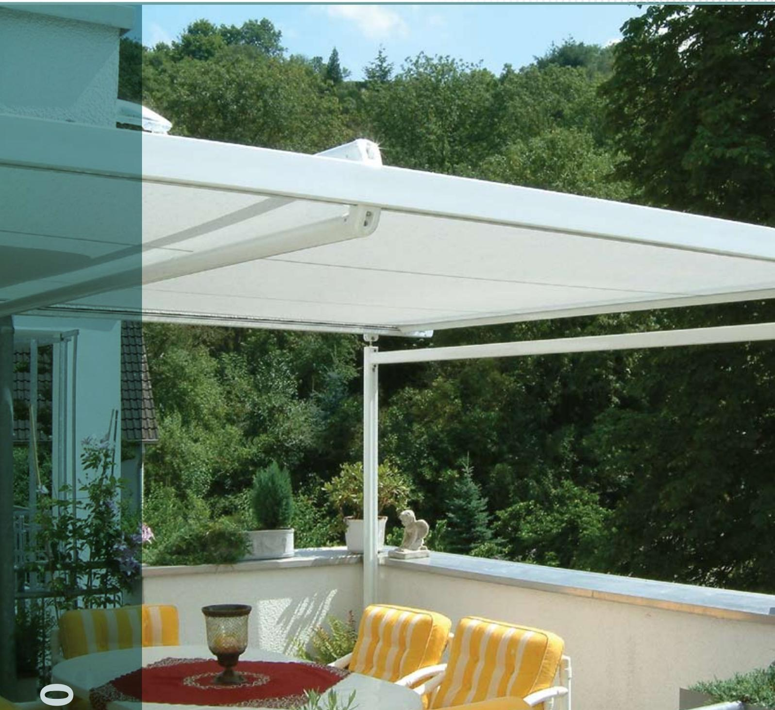
La solution idéale quand un store à bras articulés ne peut pas être posé, par exemple hauteur de fixation trop basse, trop de vent, ou avancée trop importante. Le Terraclim est en fait une structure fixe avec un store intégré. Il peut aussi fonctionner en tant que store contre la pluie muni d'une toile imperméable.
