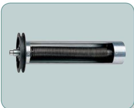
3. Le Climavelum utilise un système patenté de ressorts à torsion incorporés dans l'axe d'enroulement garantissant une tension minimale de 7 kg en position fermée et jusque 25 kg en position ouverte.
