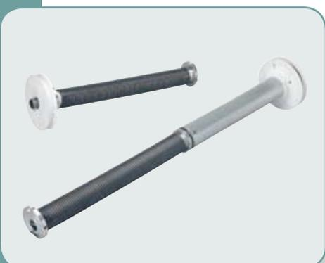
5. Le T500 utilise un système patenté de ressorts à torsion garantissant une tension sur la toile. Afin d'épargner la toile et le mécanisme, il y a 10 kg maximum sur le système à ressort en position fermée. En position complètement ouverte, une tension jusque 50 kg sera sur les deux ressorts. Les ressorts sont incorporés dans l'axe d'enroulement Ø 85mm.
